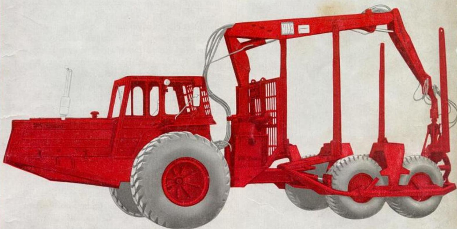
SMV *Drivax* är en allhjulsdreven, midjestyrd transportmaskin med boggiéförsedd bakropp. En ny teknisk lösning på drivningen av boggiehjulen, genialisk i sin enkelhet, löser ett svårt problem.
